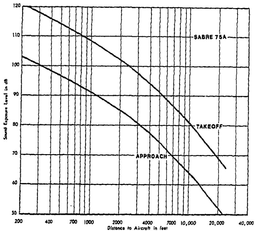
FIGURE 9. SOUND EXPOSURE LEVEL AS A FUNCTION OF DISTANCE - SABRE 75A
