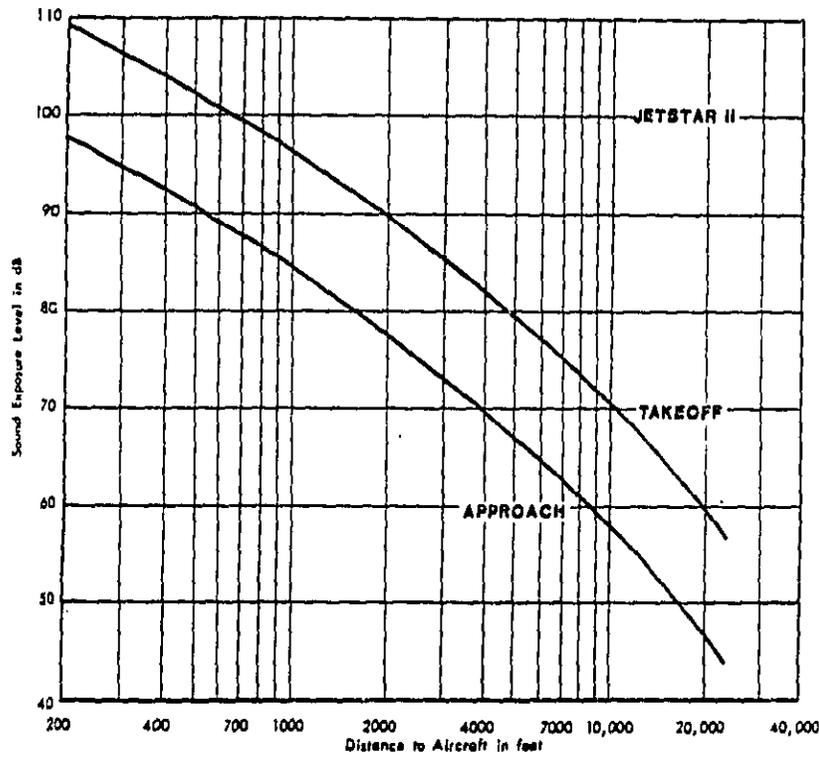
FIGURE 7. SOUND EXPOSURE LEVEL AS A FUNCTION OF DISTANCE - JETSTAR II
