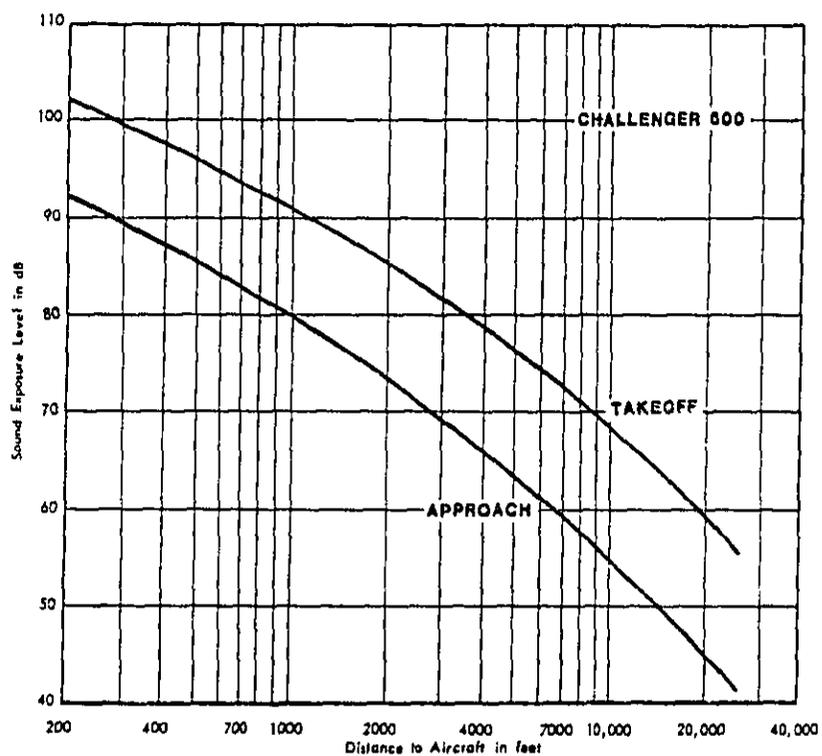
FIGURE 2. SOUND EXPOSURE LEVEL AS A FUNCTION OF DISTANCE - CHALLENGER 600
