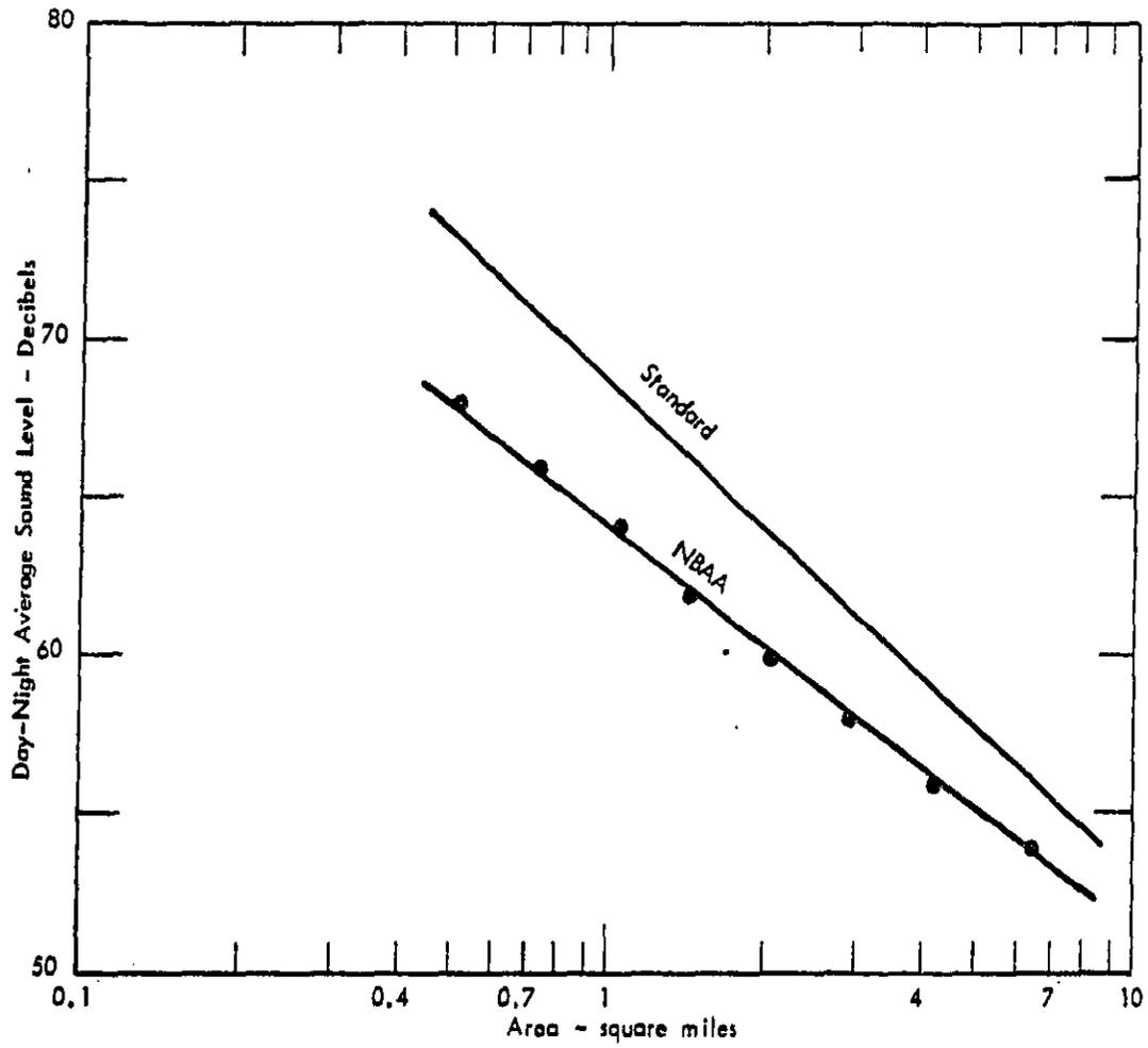
FIGURE 26. DAY-NIGHT AVERAGE SOUND LEVEL CONTOUR AREAS - 1975 COMPOSITE BUSINESS JET - 20 OPERATIONS PER DAY - STANDARD AND NBAA TAKEOFF PROCEDURES
