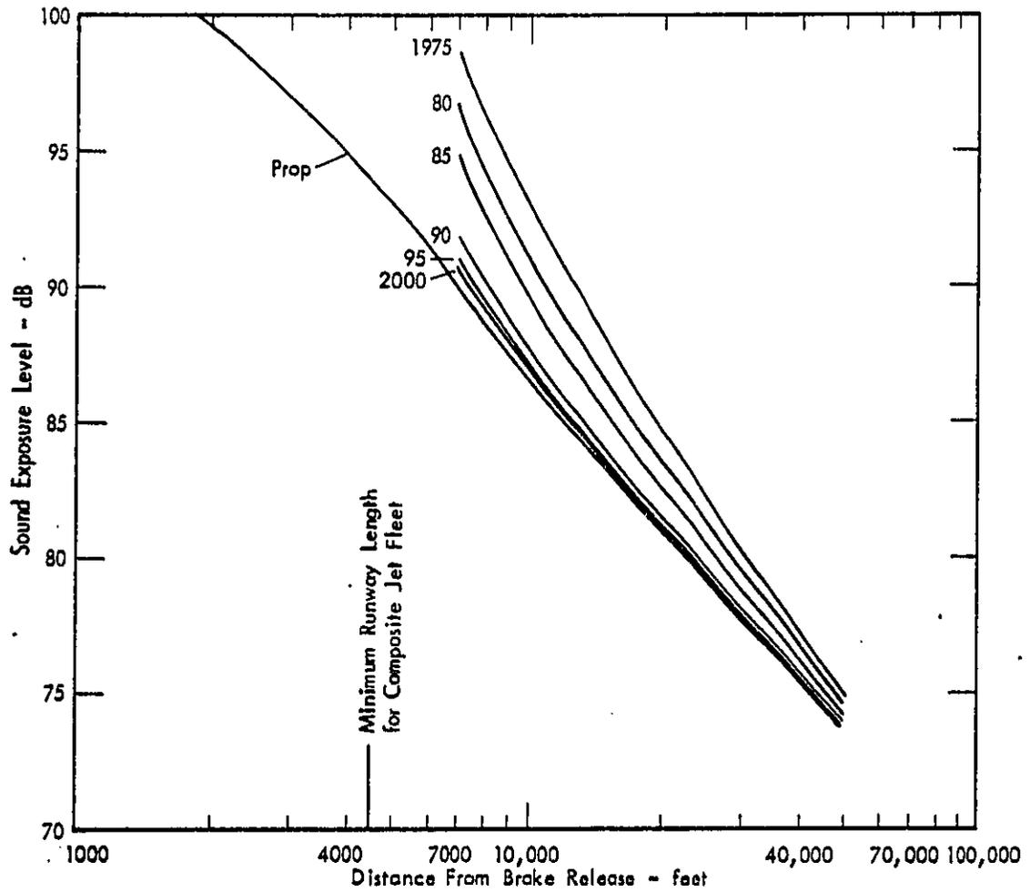
FIGURE 32. DISTANCE TO SOUND EXPOSURE LEVEL CONTOUR CLOSURE POINT - TAKEOFF MIXED FLEET - 2% JET FOR YEARS 1975 TO 2000
