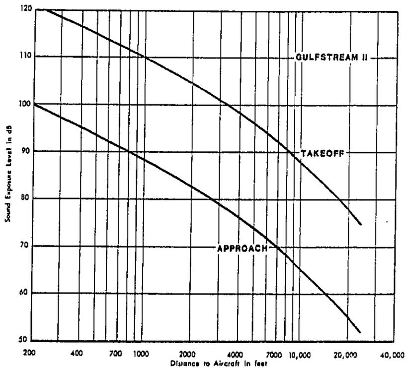
FIGURE 4. SOUND EXPOSURE LEVEL AS A FUNCTION OF DISTANCE - GULFSTREAM II
