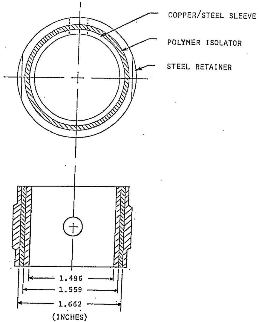
Figure 30. Resilient Cam Bearing
