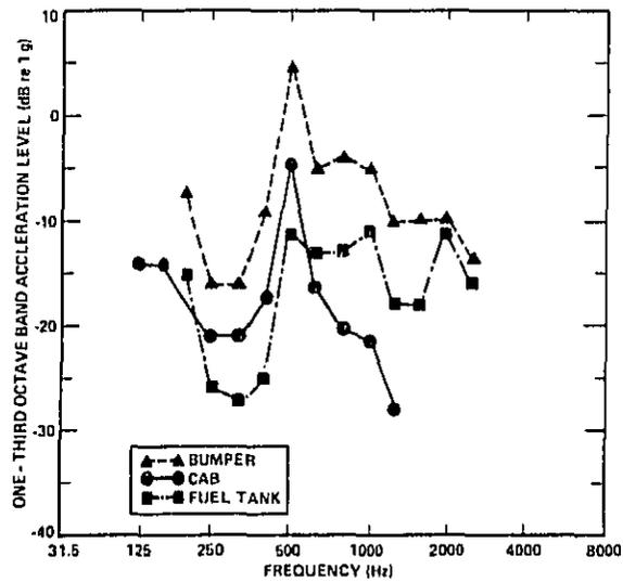
FIG. C.1. VIBRATION LEVELS ON CAB FUEL TANK AND BUMPER.
