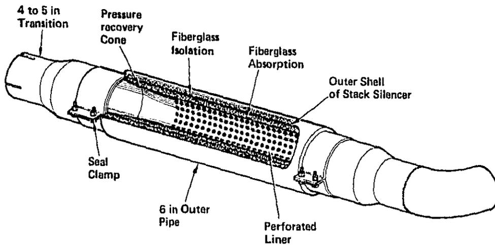
FIG. 20. VIEW OF IN-LINE SILENCER.
