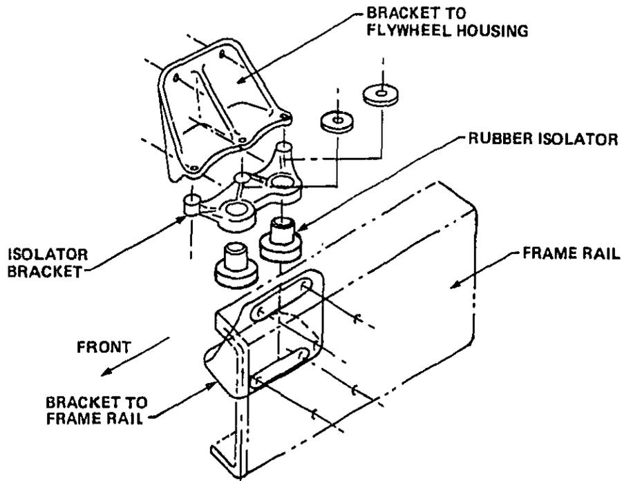
FIG. 23. ORIGINAL REAR ENGINE MOUNT CONFIGURATION.
