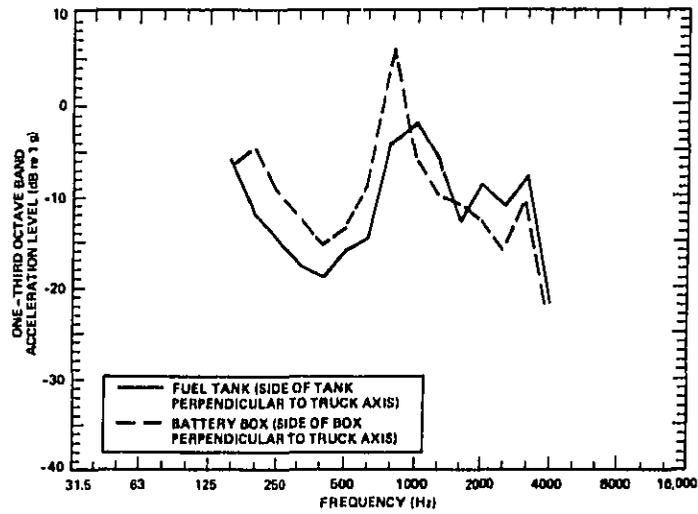
FIG. C.1. ONE-THIRD OCTAVE BAND ACCELERATION LEVELS ON FUEL TANK AND BATTERY BOX.
