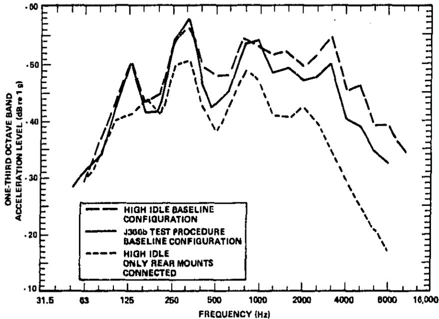
FIG. B.1. VIBRATION LEVEL ON FRAME RAIL.
