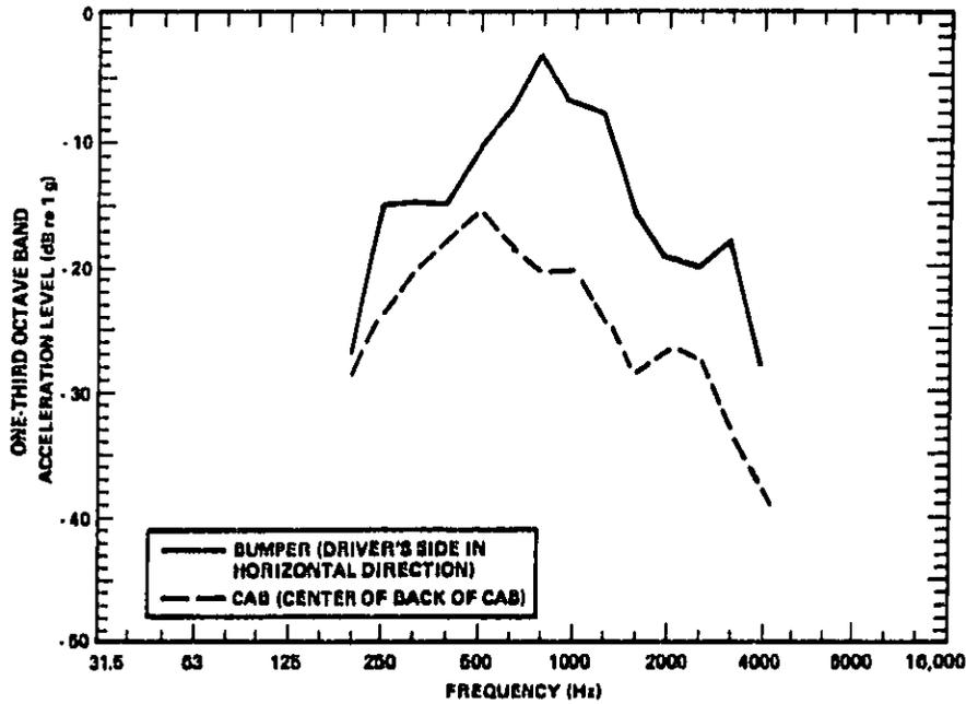
FIG. C.3. ONE-THIRD OCTAVE BAND ACCELERATION LEVELS ON BUMPER AND CAB.
