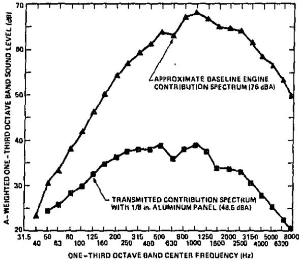
FIG. 11. ESTIMATED SPECTRAL CONTRIBUTIONS OF SOUND TRANSMITTED THROUGH ENCLOSURE PANELS.
