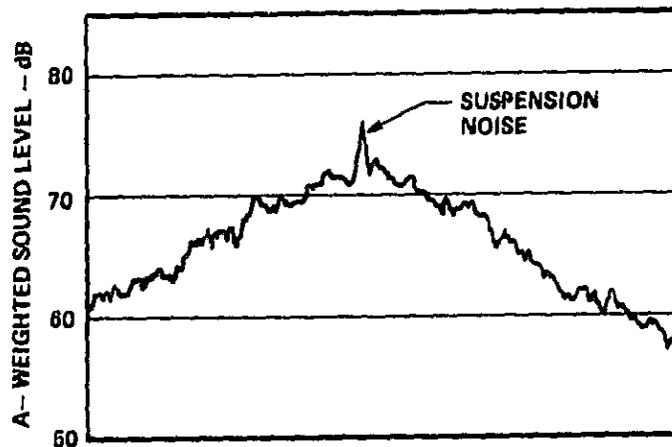
FIG. 20. ACCELERATION TEST PASSBY STRIP CHART.
