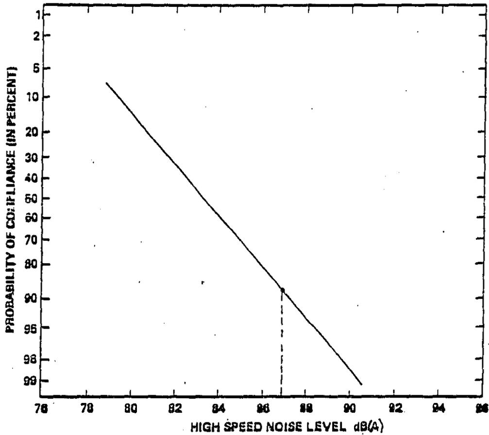
FIG. 9. ESTIMATED PROBABILITY OF POST-1978 MEDIUM AND HEAVY TRUCK COMPLIANCE AS A FUNCTION OF HIGH-SPEED NOISE LEVEL\*.
