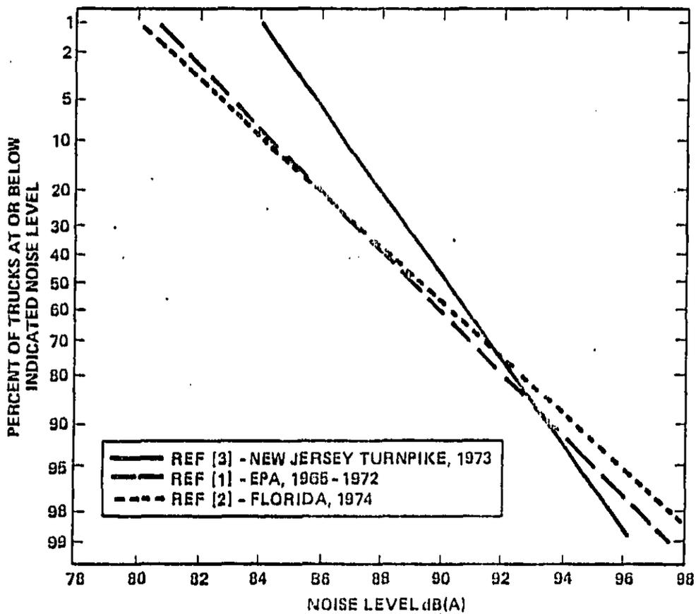
FIGURE 2. CUMULATIVE PERCENTAGE DISTRIBUTION OF TRUCK NOISE LEVELS: PRE-INTERSTATE MOTOR CARRIER REGULATION - HIGH SPEED.
