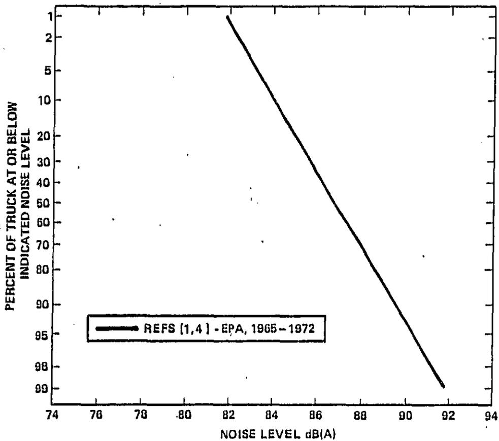
FIGURE 3. CUMULATIVE PERCENTAGE DISTRIBUTION OF TRUCK NOISE LEVELS: PRE-INTERSTATE MOTOR CARRIER REGULATION - LOW SPEED.
