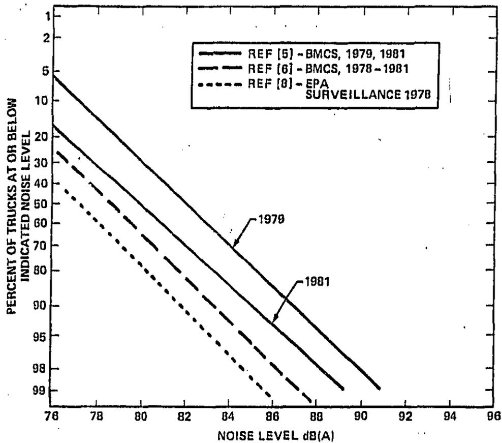
FIGURE 7. CUMULATIVE PERCENTAGE DISTRIBUTION OF TRUCK NOISE LEVELS: POST-INTERSTATE MOTOR CARRIER REGULATION - STATIONARY TEST.
