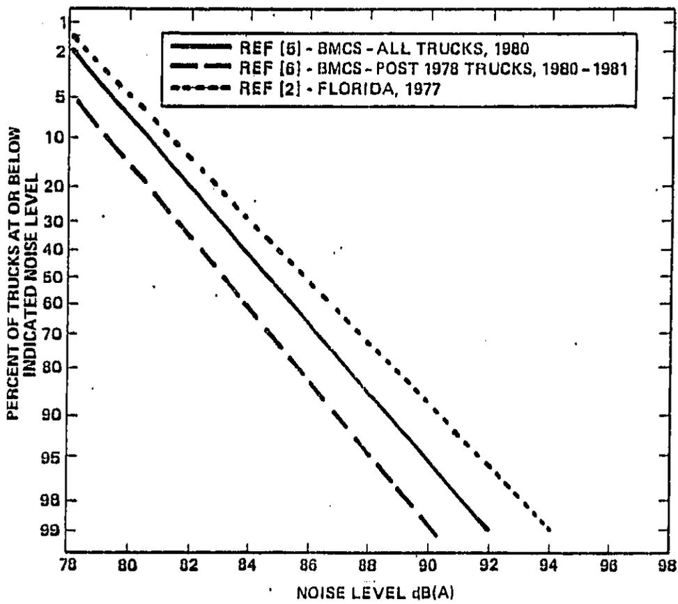
FIGURE 5. CUMULATIVE PERCENTAGE DISTRIBUTION OF TRUCK NOISE LEVELS: POST-INTERSTATE MOTOR CARRIER REGULATION - HIGH SPEED.
