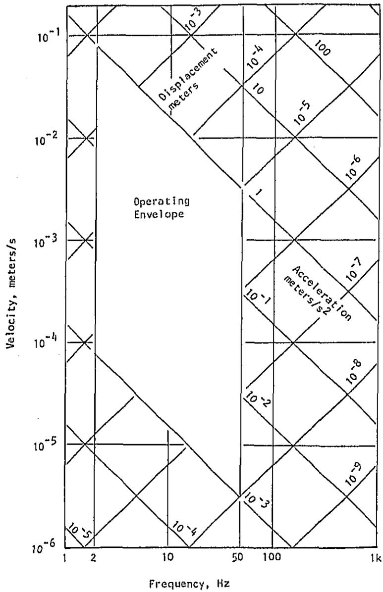
FIGURE 4-1 - INSTRUMENTATION OPERATING ENVELOPE
