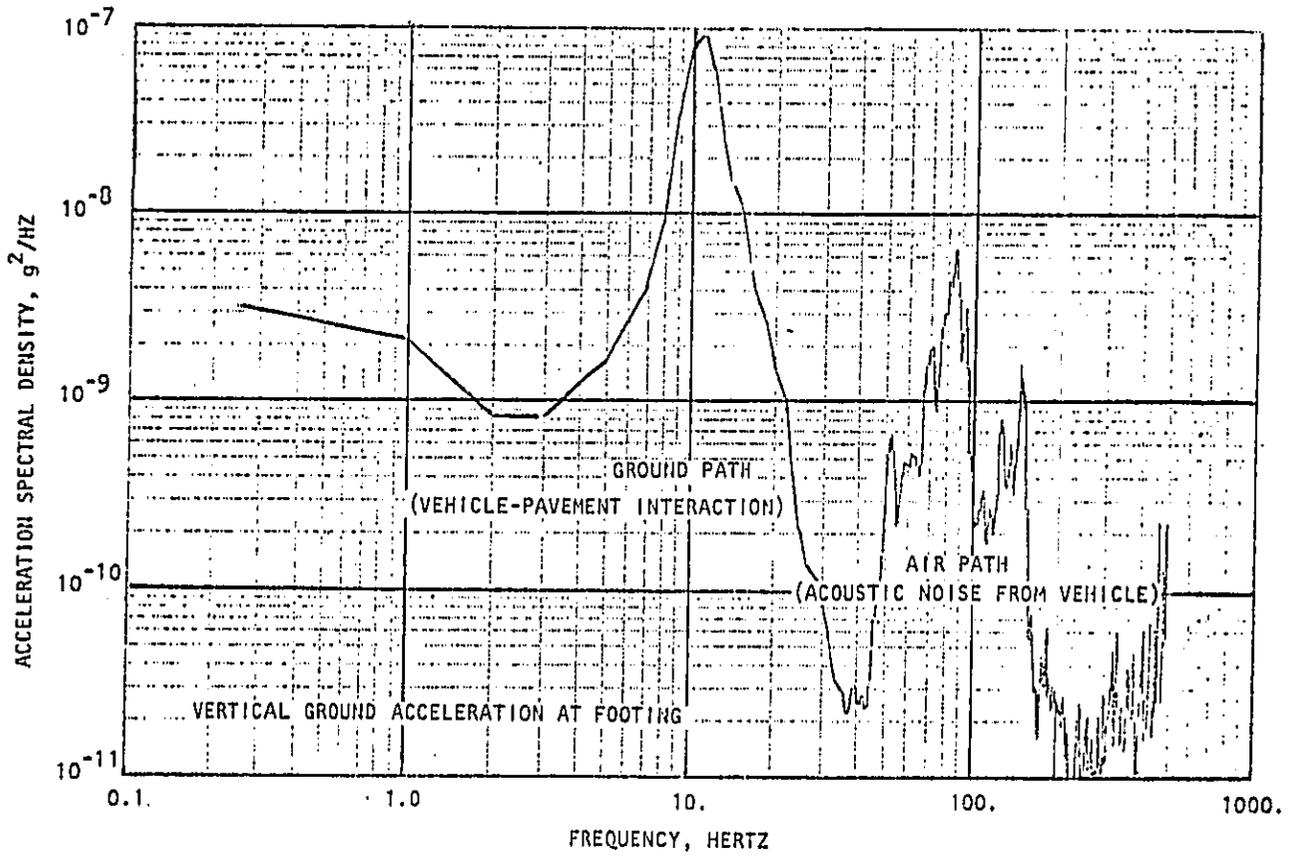
Figure 2-8. GROUND MOTION RESPONSE TO COMBINED TRAFFIC NOISE AND VIBRATION
