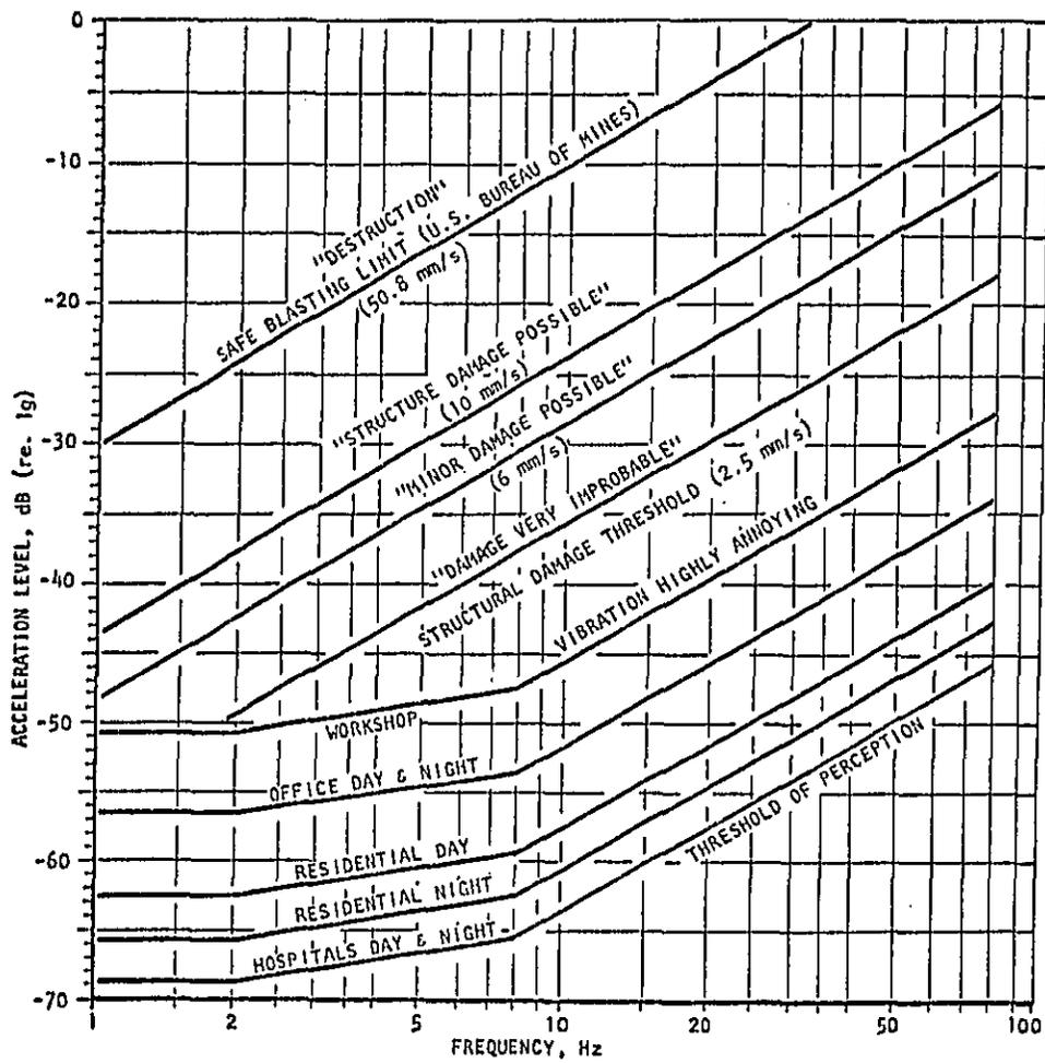
FIGURE 2-3 - CRITERIA CURVES FOR ENVIRONMENTAL VIBRATION:
