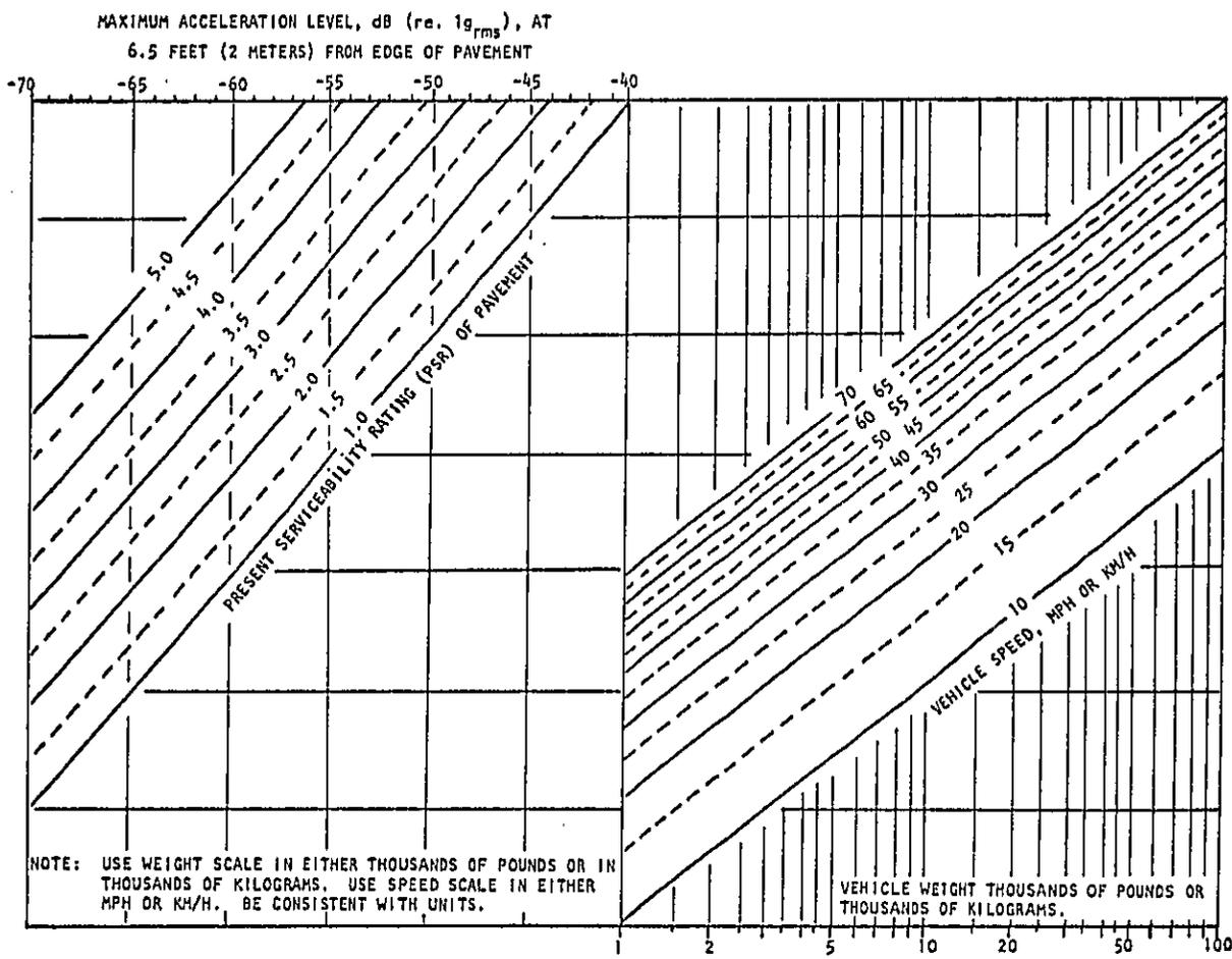
FIGURE 3-1 - DESIGN NUMOGRAPH FOR ESTIMATING THE VIBRATION REFERENCE EMISSION LEVEL
