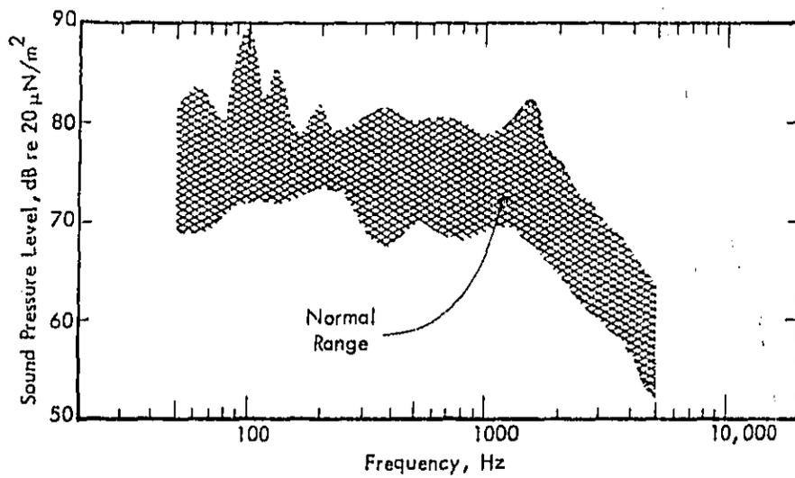
FIGURE B-2. TYPICAL HIGHWAY NOISE SPECTRA<sup>B-3</sup>
