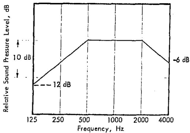
FIGURE B-5. EXTERIOR WALL RATING STANDARD CONTOUR
