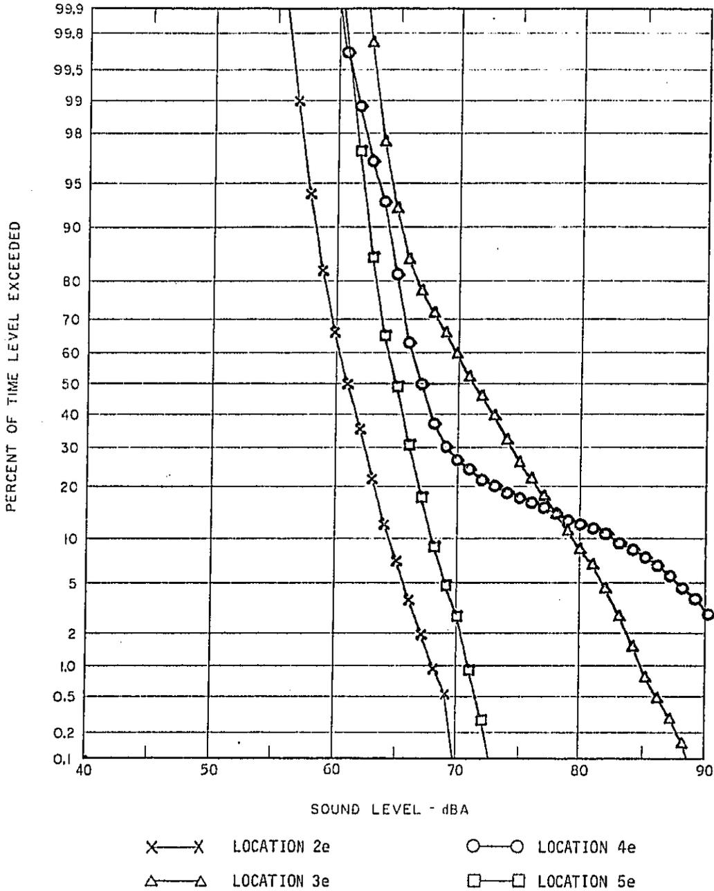
FIGURE 5 STATISTICAL DISTRIBUTION OF THE EVENING EXTERIOR NOISE ALONG THE O'HARE EXTENSION ALIGNMENT
