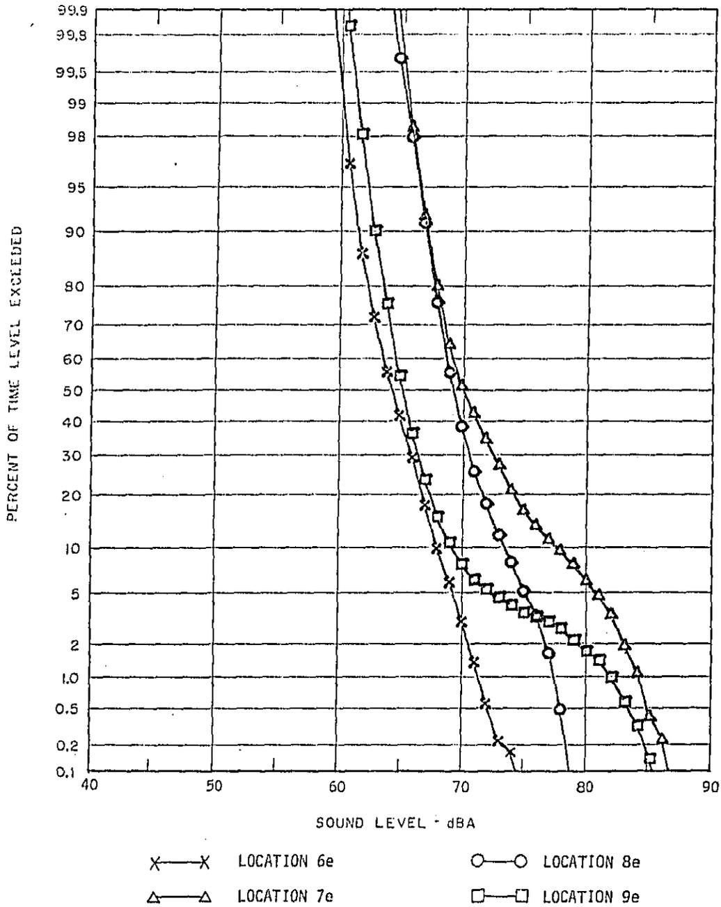
FIGURE 6 STATISTICAL DISTRIBUTION OF THE EVENING EXTERIOR NOISE ALONG THE O'HARE EXTENSION ALIGNMENT
