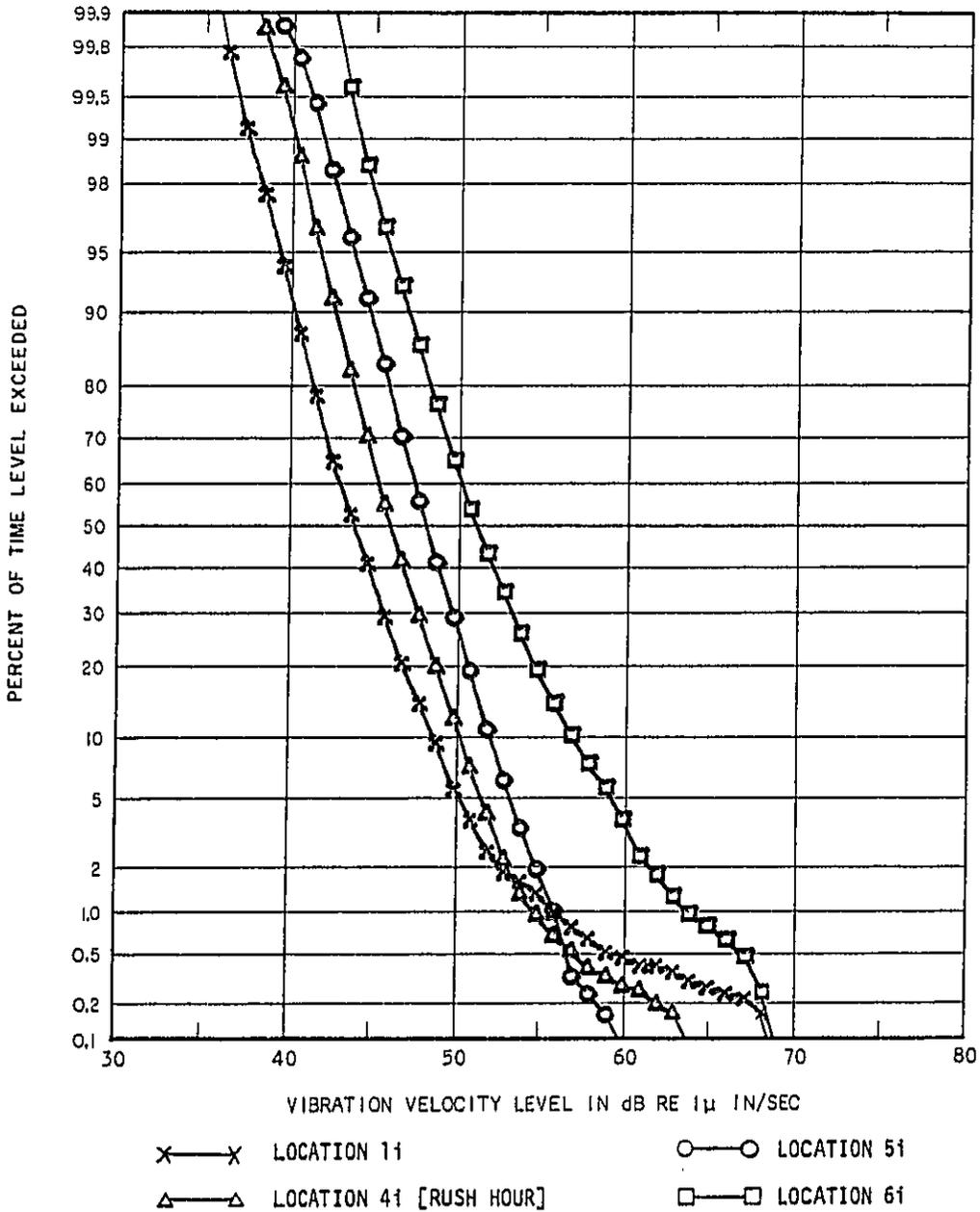
FIGURE 17 STATISTICAL DISTRIBUTION OF THE DAYTIME INTERIOR VIBRATION VELOCITY LEVELS ALONG THE O'HARE EXTENSION ALIGNMENT
