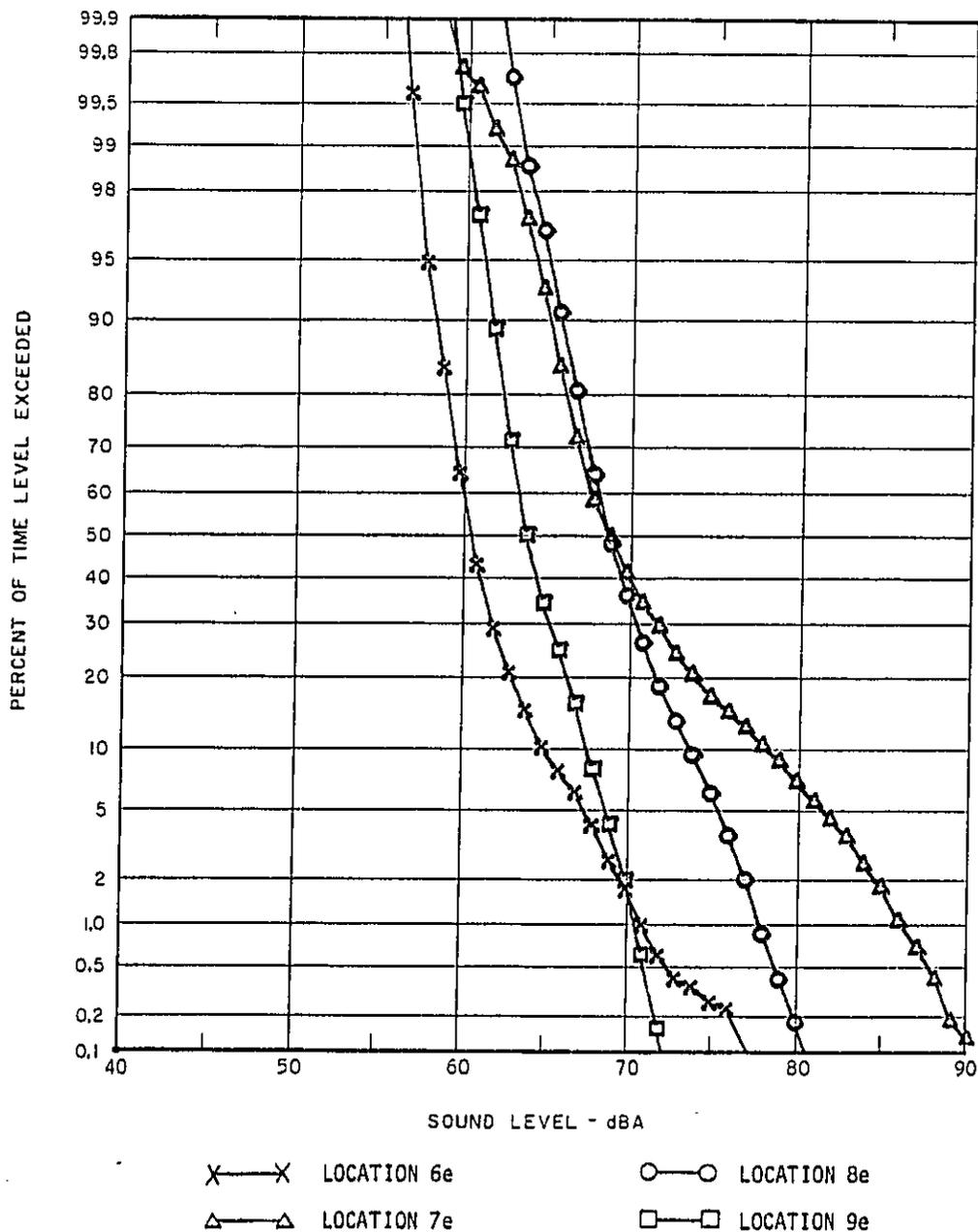
FIGURE 9 STATISTICAL DISTRIBUTION OF THE NIGHTTIME EXTERIOR NOISE ALONG THE O'HARE EXTENSION ALIGNMENT
