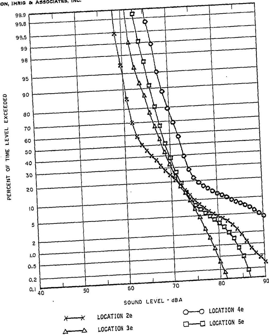
FIGURE 2 STATISTICAL DISTRIBUTION OF THE DAYTIME EXTERIOR NOISE ALONG THE O'HARE EXTENSION ALIGNMENT
