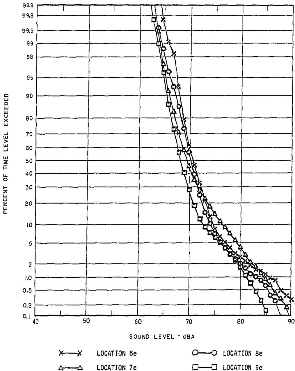
FIGURE 3 STATISTICAL DISTRIBUTION OF THE DAYTIME EXTERIOR NOISE ALONG THE O'HARE EXTENSION ALIGNMENT
