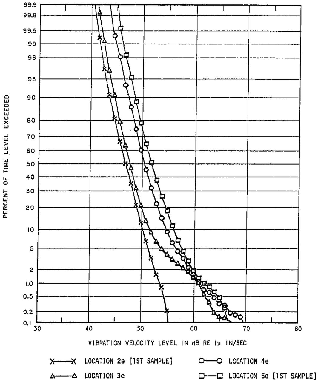
FIGURE 14 STATISTICAL DISTRIBUTION OF THE DAYTIME EXTERIOR VIBRATION VELOCITY LEVELS ALONG THE O'HARE EXTENSION ALIGNMENT
