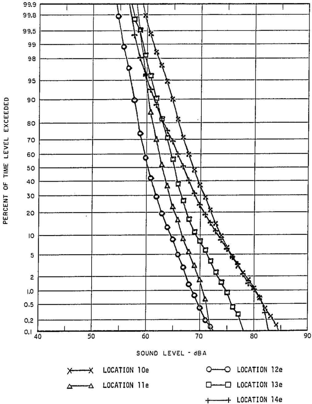
FIGURE 10 STATISTICAL DISTRIBUTION OF THE NIGHTTIME EXTERIOR NOISE ALONG THE O'HARE EXTENSION ALIGNMENT
