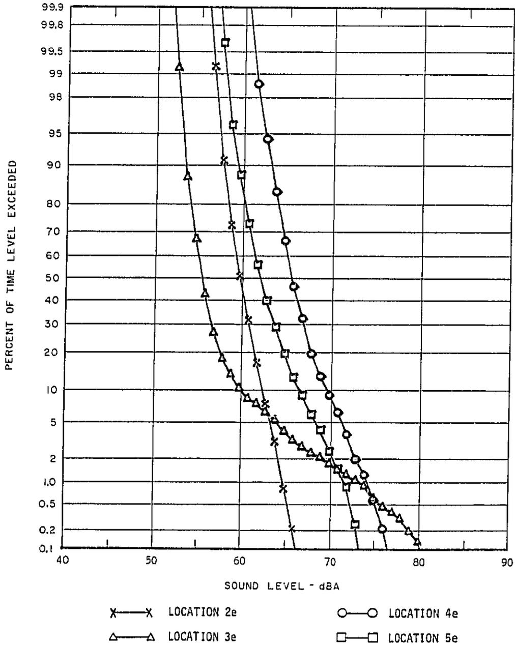
FIGURE 8 STATISTICAL DISTRIBUTION OF THE NIGHTTIME EXTERIOR NOISE ALONG THE O'HARE EXTENSION ALIGNMENT
