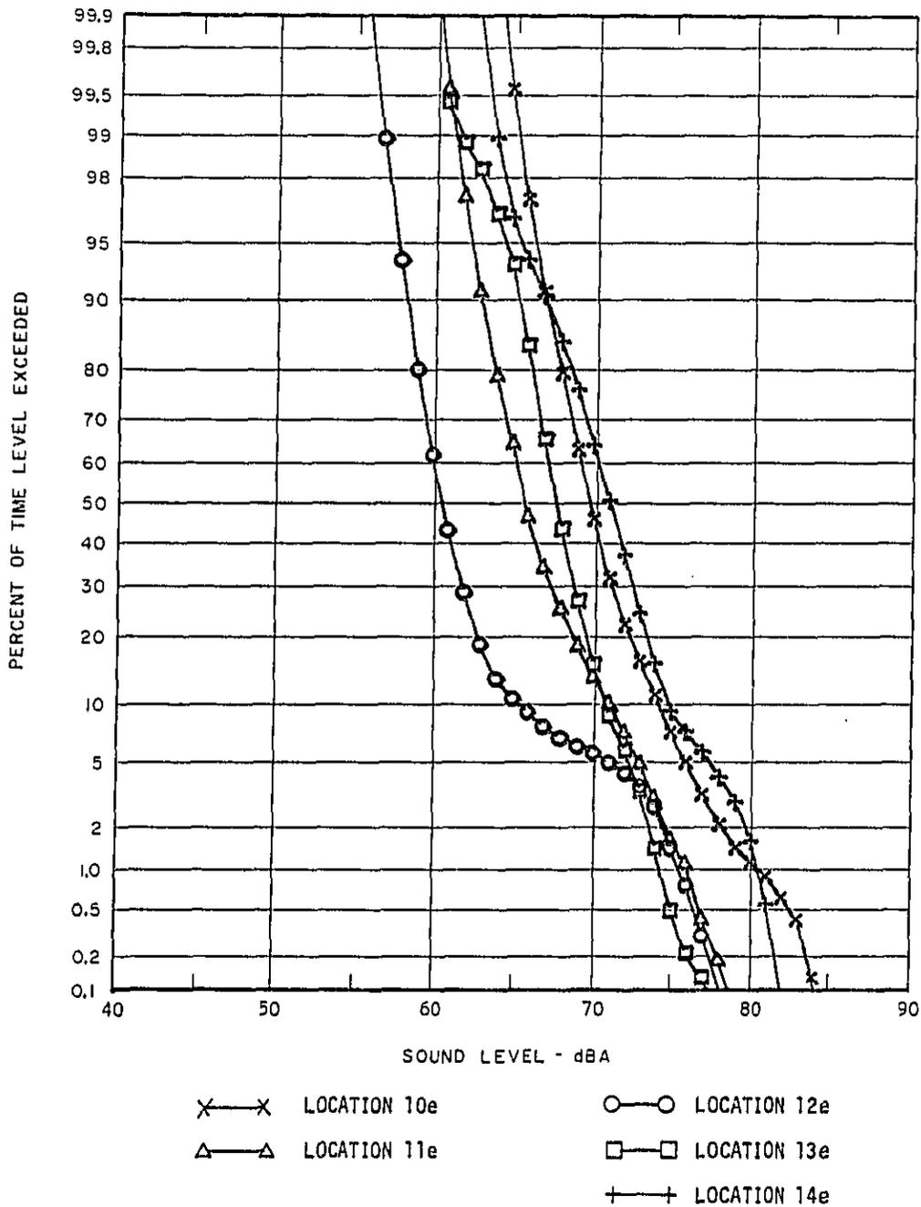
FIGURE 7 STATISTICAL DISTRIBUTION OF THE EVENING EXTERIOR NOISE ALONG THE O'HARE EXTENSION ALIGNMENT
