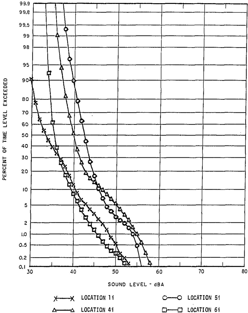
FIGURE 11 STATISTICAL DISTRIBUTION OF THE DAYTIME INTERIOR NOISE ALONG THE O'HARE EXTENSION ALIGNMENT
