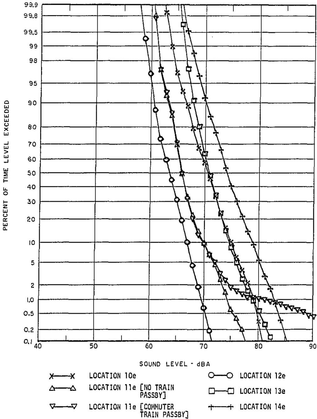
FIGURE 4 STATISTICAL DISTRIBUTION OF THE DAYTIME EXTERIOR NOISE ALONG THE O'HARE EXTENSION ALIGNMENT
