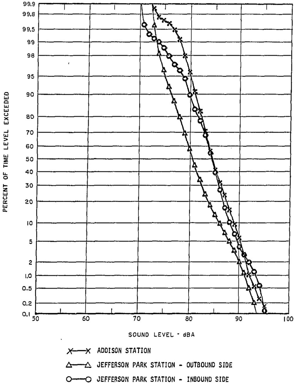
FIGURE 24 STATISTICAL DISTRIBUTION OF THE DAYTIME PLATFORM NOISE OBSERVED AT 2 STATIONS LOCATED IN THE KENNEDY EXPRESSWAY MEDIAN
