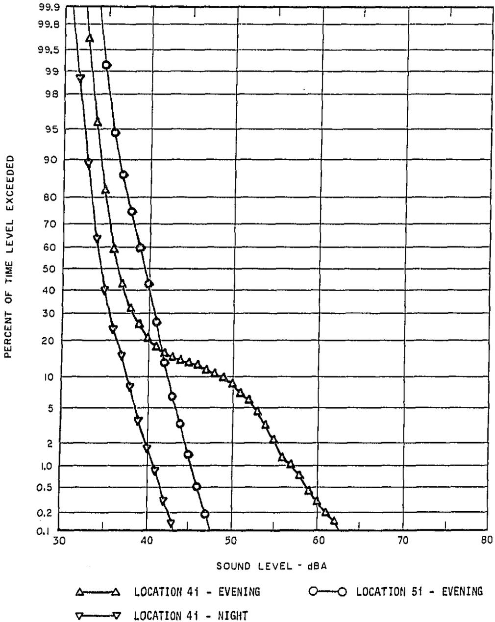
FIGURE 12 STATISTICAL DISTRIBUTION OF THE EVENING AND NIGHTTIME INTERIOR NOISE ALONG THE O'HARE EXTENSION ALIGNMENT
