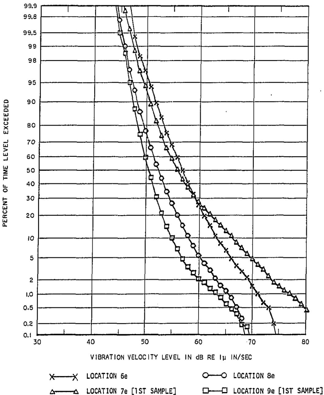
FIGURE 15 STATISTICAL DISTRIBUTION OF THE DAYTIME EXTERIOR VIBRATION VELOCITY LEVELS ALONG THE O'HARE EXTENSION ALIGNMENT
