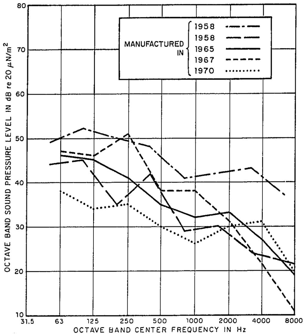
FIG. 4. SOUND PRESSURE LEVELS OF VARIOUS REFRIGERATORS
