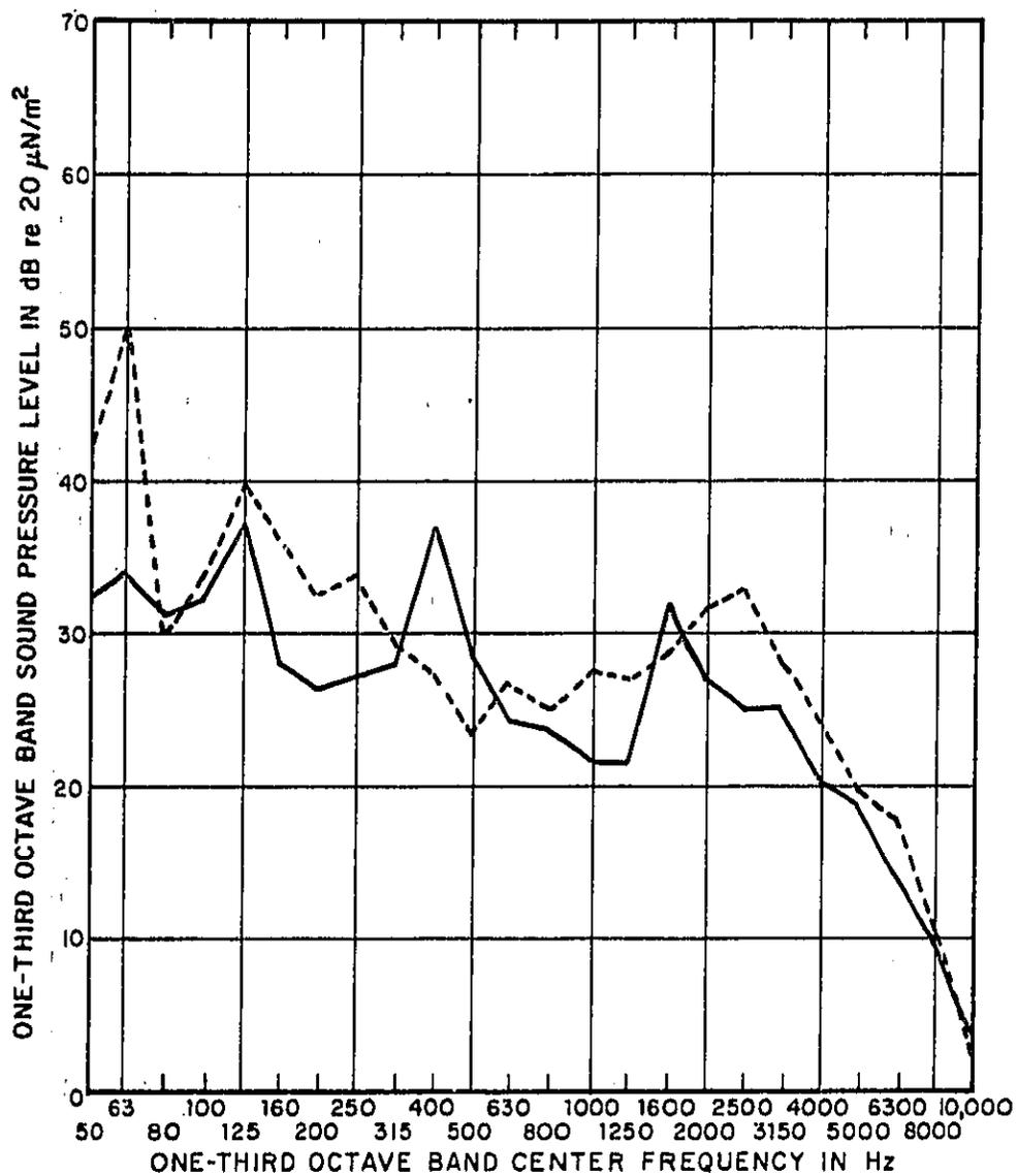
FIG. A.21 SOUND PRESSURE LEVELS FROM TWO FREEZERS
