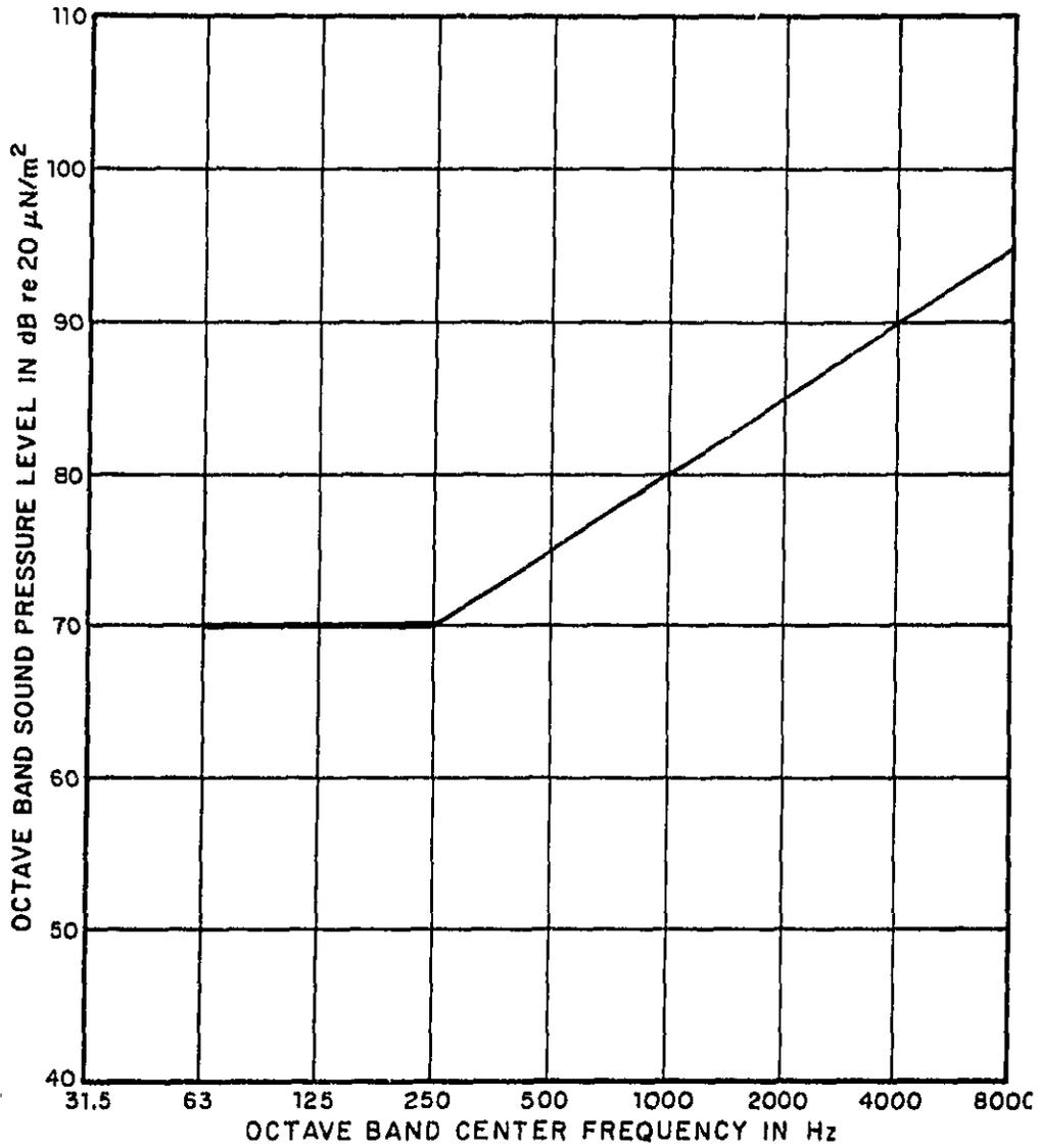
FIG. A.44 TYPICAL SOUND PRESSURE LEVEL FROM STEAM VALVE
