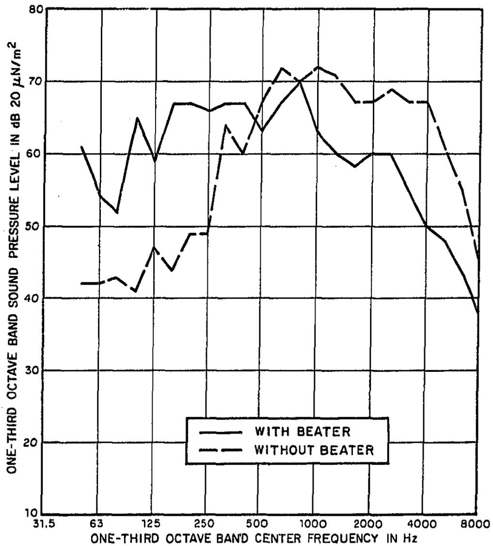
FIG. 12. SOUND PRESSURE LEVELS OF TWO UPRIGHT VACUUM CLEANERS
