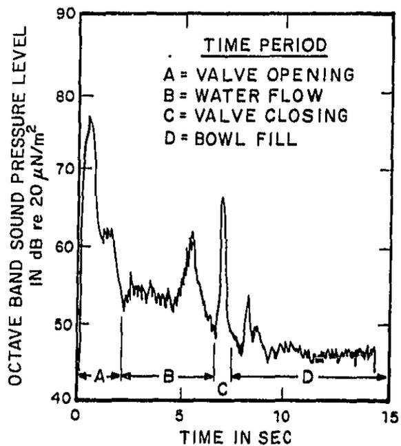
FIG. 14, TIME HISTORY OF SOUND PRESSURE LEVEL IN 250 HZ OCTAVE BAND FOR A FLUSH VALVE WATER CLOSET.
