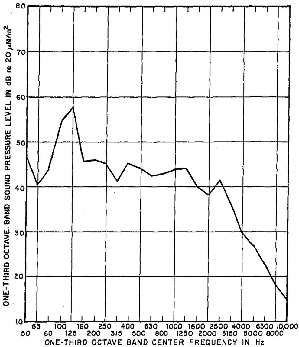
FIG. A.13 SOUND PRESSURE LEVELS FROM A DEHUMIDIFIER
