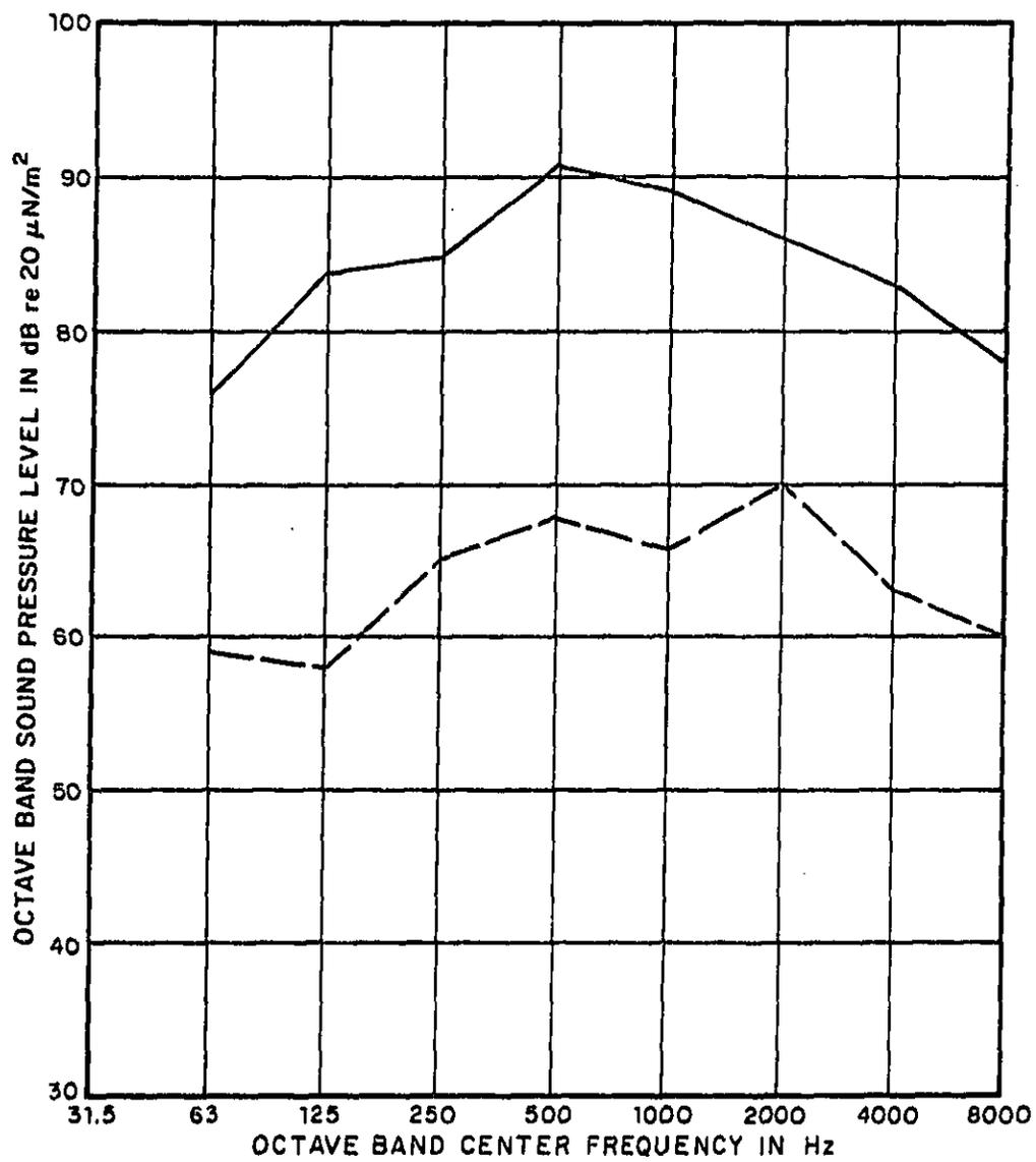
FIG. A.43 RANGE OF SOUND PRESSURE LEVELS FROM PUMPS
