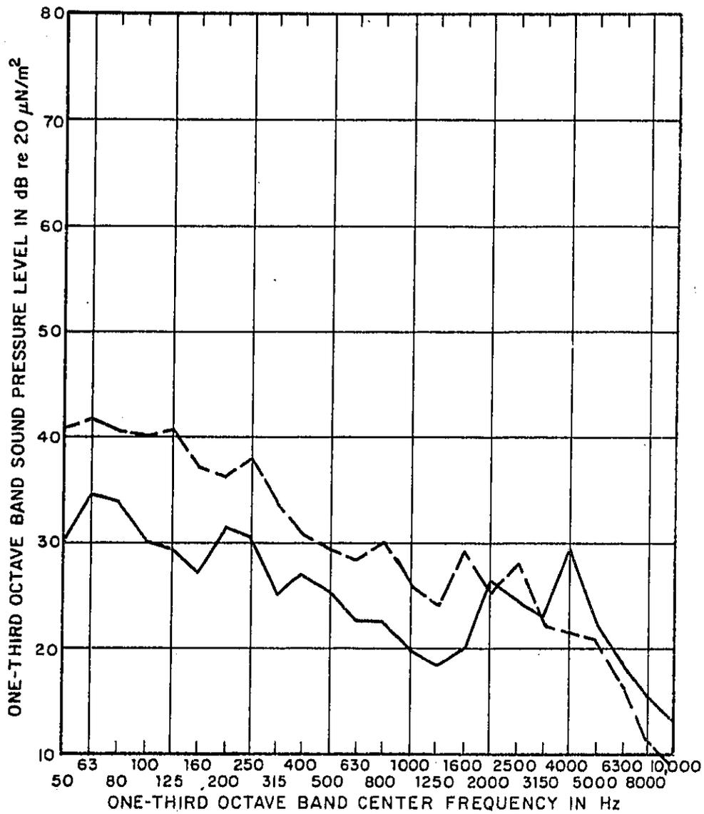
FIG. A.33 SOUND PRESSURE LEVELS FROM TWO REFRIGERATORS
