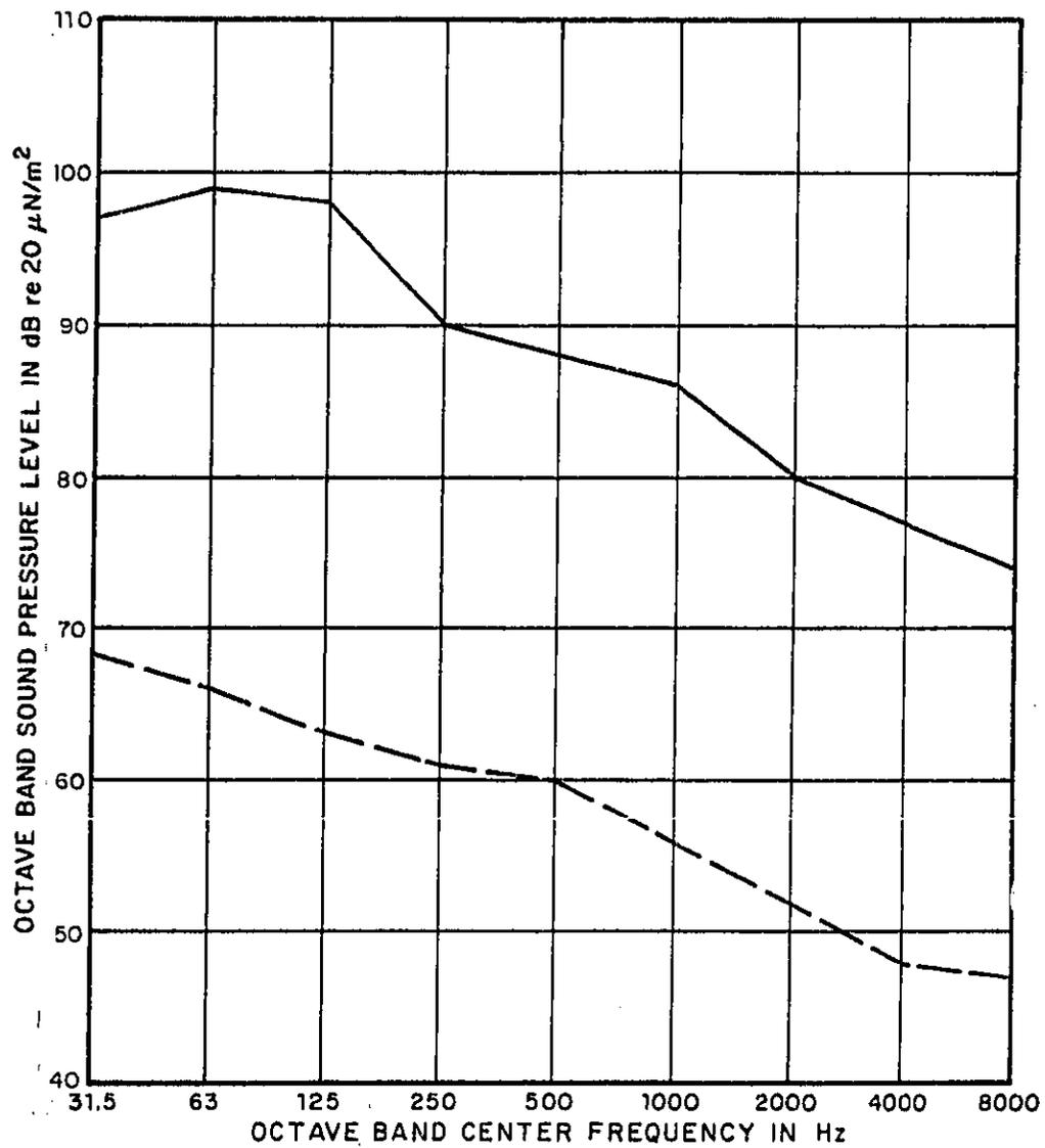
FIG. A.53 RANGE OF SOUND PRESSURE LEVELS FROM BOILERS
