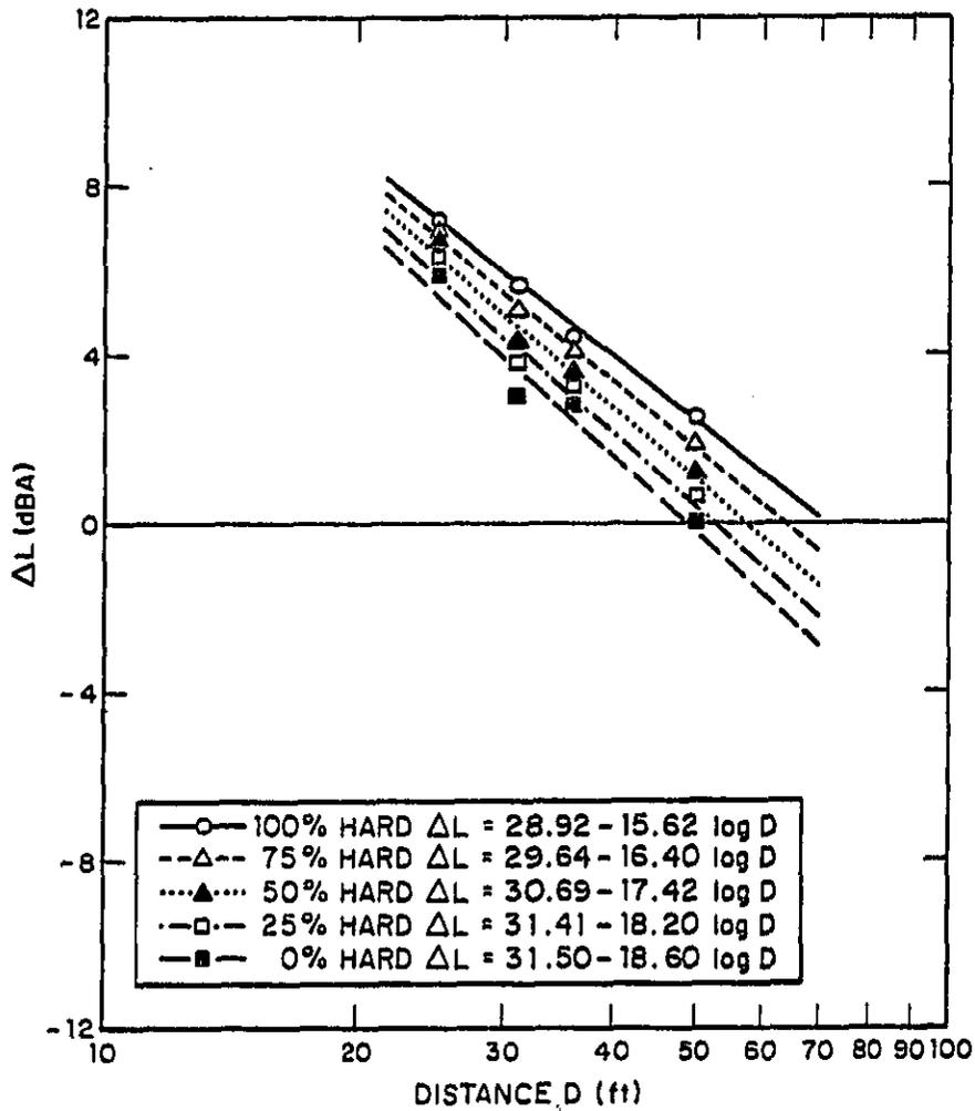
FIG. 5.4. HARD SITE/SOFT SITE NOISE LEVEL DIFFERENCES AS A FUNCTION OF MICROPHONE DISTANCE: IMI - GAS - LEFT SIDE.
