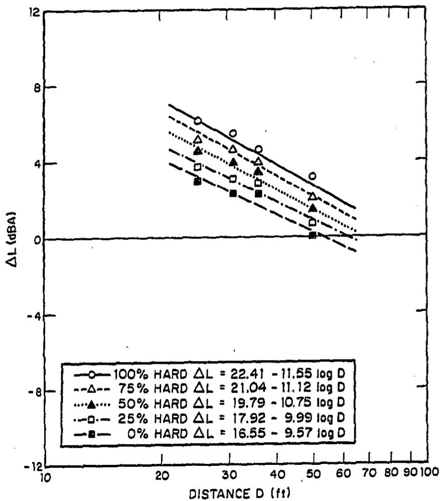
FIG. 5.1. HARD SITE/SOFT SITE NOISE LEVEL DIFFERENCES AS A FUNCTION OF MICROPHONE DISTANCE: IMI - DIESEL - RIGHT SIDE.
