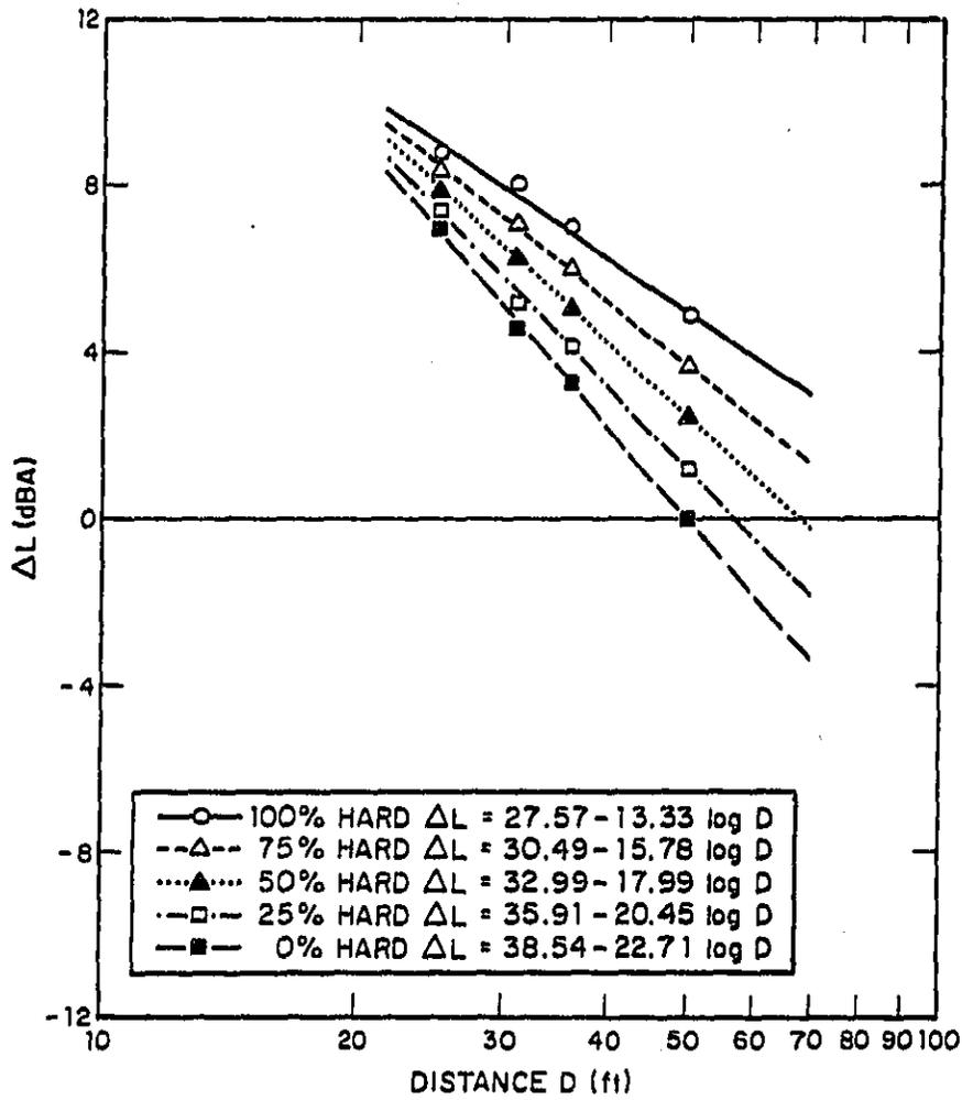
FIG. 5.3. HARD SITE/SOFT SITE NOISE LEVEL DIFFERENCES AS A FUNCTION OF MICROPHONE DISTANCE: IMI - GAS - RIGHT SIDE.
