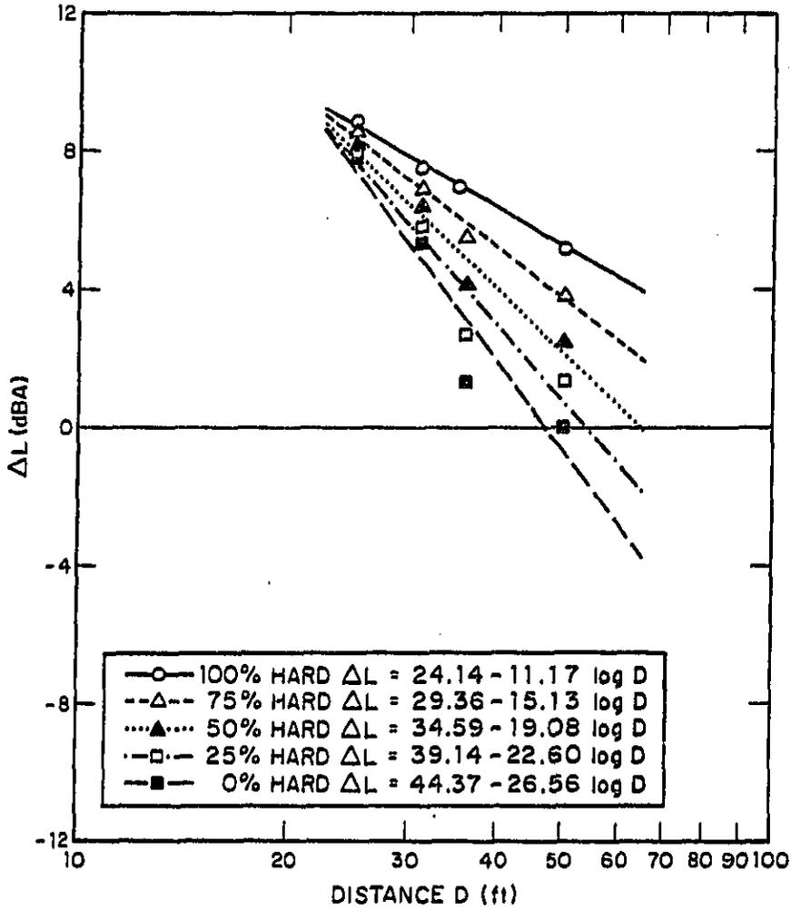
FIG. 5.10. HARD SITE/SOFT SITE NOISE LEVEL DIFFERENCES AS A FUNCTION OF MICROPHONE DISTANCE: GAS PASSBYS — 35 MPH — LEFT SIDE.
