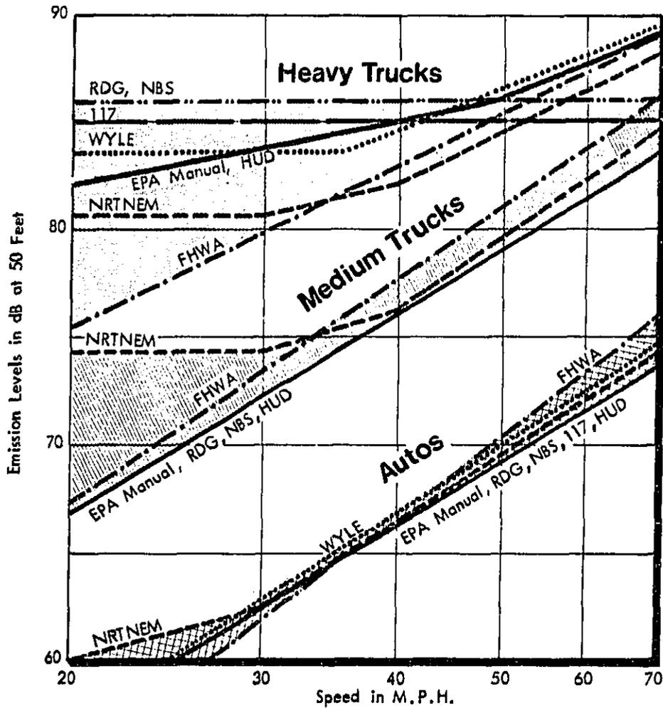
FIGURE C-3. COMPARISON OF VEHICLE NOISE EMISSION LEVELS
