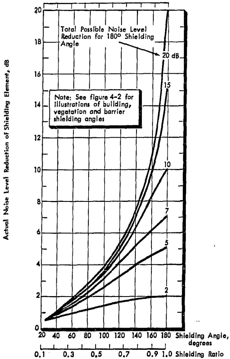
FIGURE 4-12. ACTUAL NOISE LEVEL REDUCTION OF SHIELDING ELEMENTS AS A FUNCTION OF SHIELDING ANGLE
