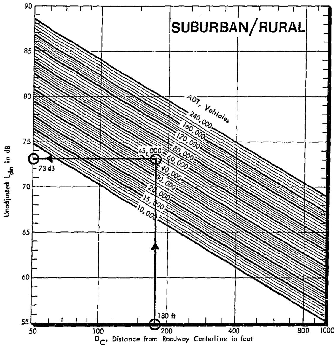
ILLUSTRATION 3-2. USE OF  $L_{dn}$  CHART FOR ESTIMATING UNADJUSTED  $L_{dn}$
