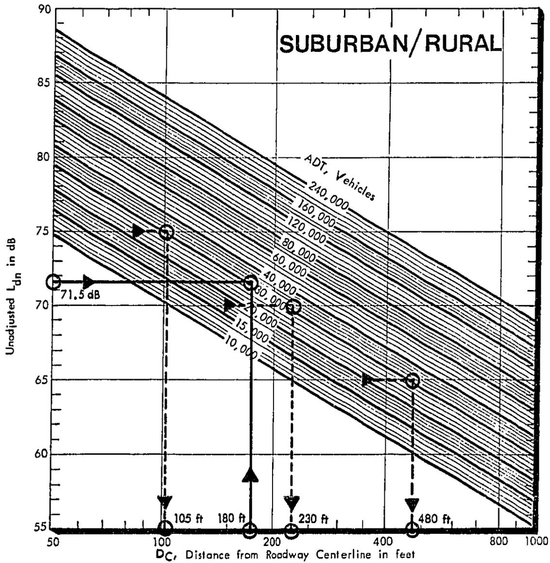
ILLUSTRATION 3-4. USE OF  $L_{dn}$  CHART FOR ESTIMATING  $L_{dn}$  CONTOUR DISTANCES
