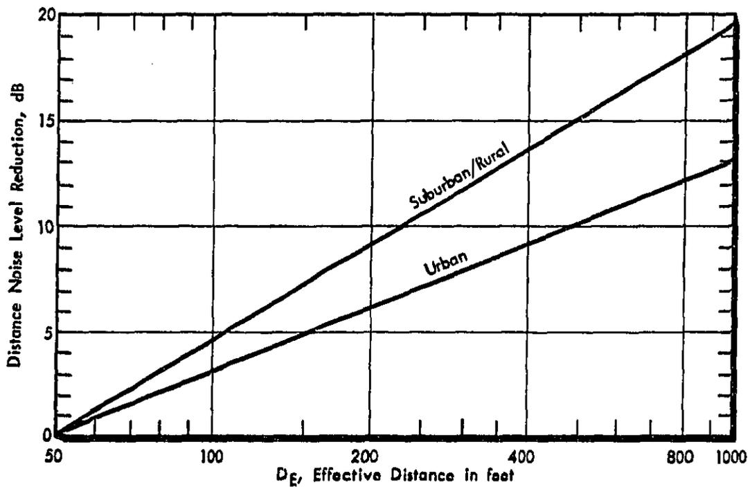
FIGURE 4-10. NOISE LEVEL REDUCTION DUE TO DISTANCE
