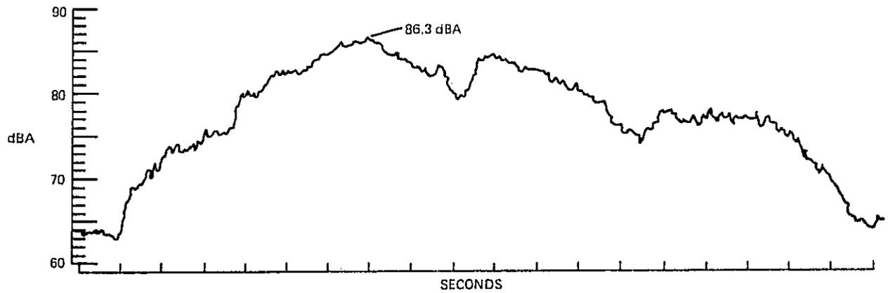
MAXIMUM ACCELERATION TEST: TRACTOR PLUS TRAILER (GCW = 72,600 lb)
