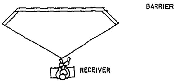
(A) PLAN VIEW OF BARRIER TURNED AT ENDS
