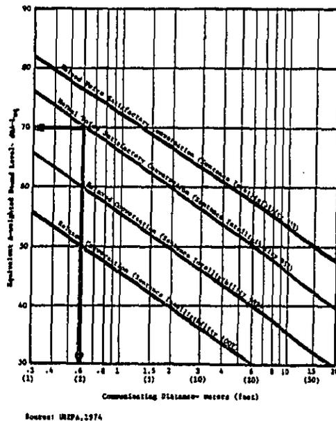
Figure 15 MAXIMUM DISTANCE OUTDOORS OVER WHICH CONVERSATION IS CONSIDERED TO BE SATISFACTORILY INTELLIGIBLE
